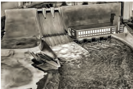
10 Situační (3D) model vodního díla Orlík, kde se modeloval průtok přelivem a spodními výpustěmi a stabilita vývaru a přilehlého koryta. Na obrázku průtok přelivem (Výzkumný ústav vodohospodářský T. G. Masaryka, 1960).
