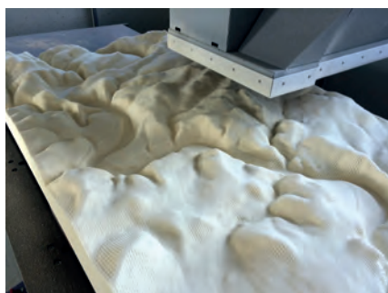
07 Frézování povrchu modelu.
