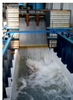
06 Přeliv a vývar vodního díla Orlík. Předmětem výzkumu byla hydraulická funkce za stavů, které překračují návrhové podmínky převádění povodňových průtoků uvažované v projektu. Podnětem k výzkumu byly zejména zkušenosti z povodně v srpnu 2002, kdy v důsledku výpadku vodní elektrárny tekli přelivními poli podstatně větší průtok (při překročení max. hladiny o 1,5 m), než se uvažovalo v projektu (Fakulta stavební ČVUT v Praze, 2009).
