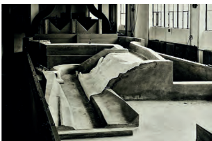
12 Model jedné z nerealizovaných variant přehrady Štěchovice se skluzem bezpečnostního přelivu umístěného mimo hráz na levém svahu (Výzkumný ústav vodohospodářský T. G. Masaryka, 1931).
