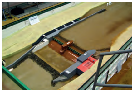
03 Plavební stupeň České Vrbné. Cílem výzkumu bylo posouzení popř. upřesnění dispozičního schématu včetně nautických zkoušek. Výzkum navazoval na podrobný výzkum plavební komory v měřítku 1:7, který byl realizován na objektovém hydraulickém modelu v roce 2008 (Fakulta stavební ČVUT v Praze, 2009).
