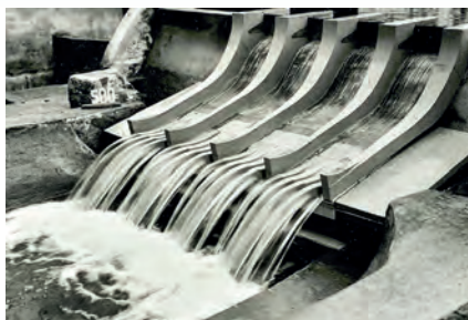
01 Vodní dílo Slapy – Fyzikální model bezpečnostního přelivu a vývaru, převádění průtoku 500 m 3 /s. (VÚV TGM – Výzkumný ústav vodohospodářský T. G. Masaryka, 50. léta 20. stol.).
