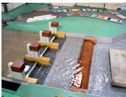
05 Přístav Hluboká nad Vltavou. Cílem výzkumu bylo ověření a optimalizace dispozičního uspořádání přístavu z hlediska plavebních podmínek a posouzení jednotlivých objektů z hlediska proudových poměrů a splaveninového režimu (Fakulta stavební ČVUT v Praze, 2010).
